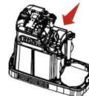
⑳ Válvula solenoide montada en caja de cinco vías
