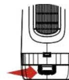
① Presione el botón de encendido/apagado para apagar la máquina.
