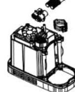
⑦ Retire el cable y retire el arnés de la válvula solenoide.
