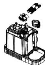
⑦ Retire el cable y retire el mazo de la válvula solenoide.
