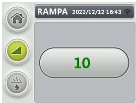
2. Gire la rueda de control para seleccionar el tiempo de rampa y presione la rueda de control para confirmar la selección. Cuando la función Rampa esté activada, el ventilador emite
