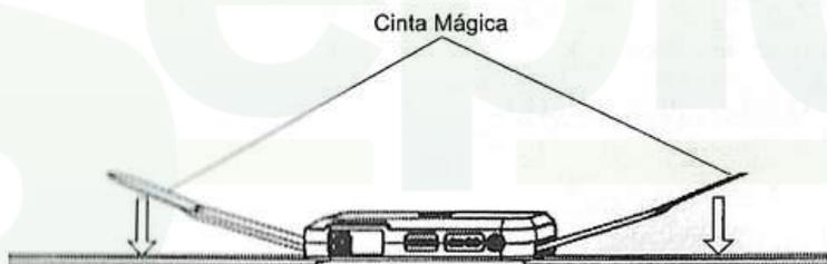
Fig. 9-6 Instalación de la Correa de la Grabadora H2
