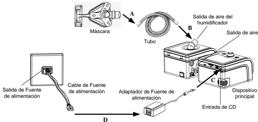
A. Conectar un extremo del tubo a la mascarilla ya montada.
