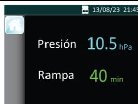
B. Desde la interfaz principal que se muestra arriba, presione y mantenga presionado el **Botón de Rampa** durante tres segundos. La pantalla muestra la interfaz de configuración inicial, como se muestra en la siguiente figura:
