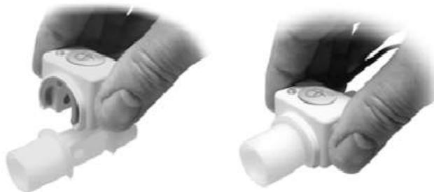
*Figura 13: Colocación del sensor de vías aéreas*
